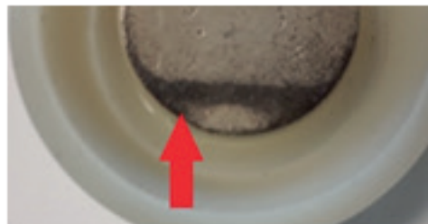
Abbildung 14: Fehlerbild - Verfärbung der Elektrode
