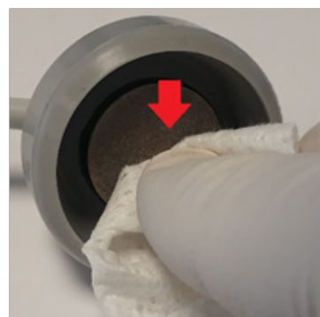
Figure 2 : Nettoyer la surface de contact
