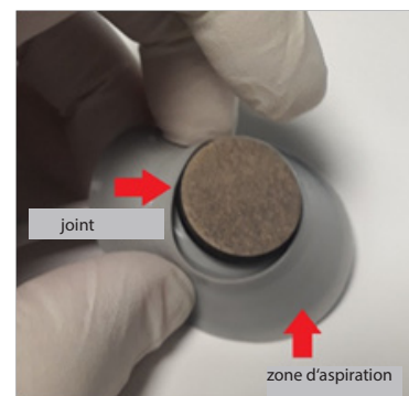
Figure 3 : Nettoyage du dôme d'aspiration intérieur
