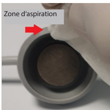
Figure 6 : Nettoyage du dôme d'aspiration extérieur
