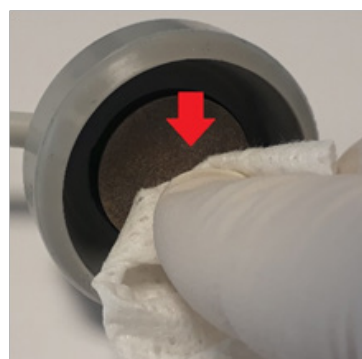
Figure 7 : Nettoyer la surface de contact (électrode)
