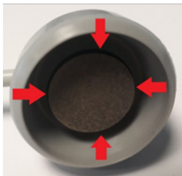
Figure 15 : Vérifiez la position du dôme d'aspiration sur le boîtier de l'électrode
