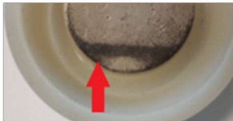
Figure 14 : Image d'erreur – décoloration de l'électrode
