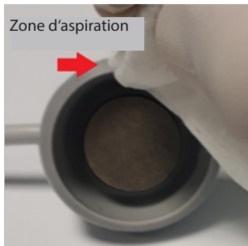
Figure 1 : Nettoyage du dôme d'aspiration extérieur
