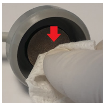
Figura 7: Pulire le superfici di contatto (elettrodo)
