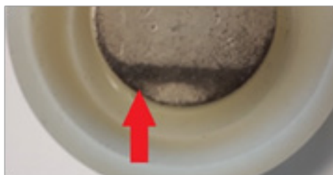
Figura 14: Immagine errata- Decolorazione degli elettrodi
