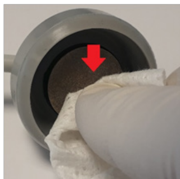
Figura 2: Pulire le superfici di contatto
