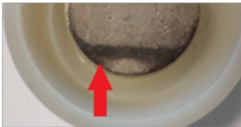
Afbeelding 14: Foutbeeld – Verkleuring van de elektrode
