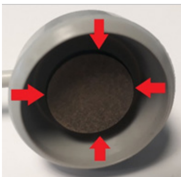
Afbeelding 15: Controleer de positie van de zuigkap op de elektrodebehuizing
