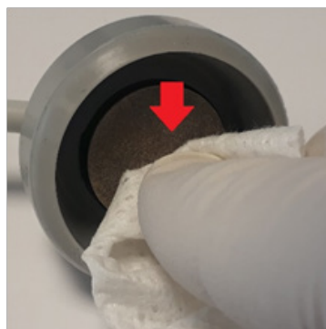
Afbeelding 7: Contactvlak reinigen (elektrode)
