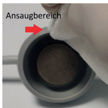
Afbeelding 1: Zuigdom buiten reinigen
