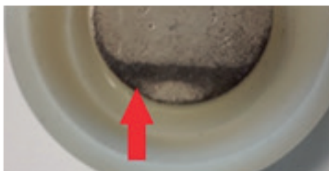
Afbeelding 14: Foutbeeld – Verkleuring van de elektrode
