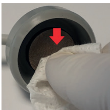
Afbeelding 7: Contactvlak reinigen (elektrode)
