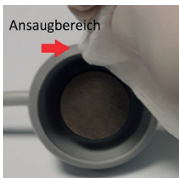
Afbeelding 6: Zuigdom buiten reinigen
