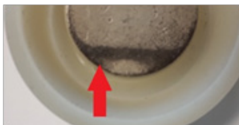
Afbeelding 14: Foutpatroon - verkleuring van de elektrode
