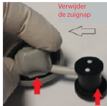
Figuur 11: Verwijder de afzuigkap
