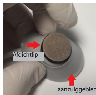
Figuur 3: Zuigkoepel reinigen van binnen
