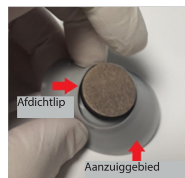
Afbeelding 8: Zuigkoepel binnen reinigen
