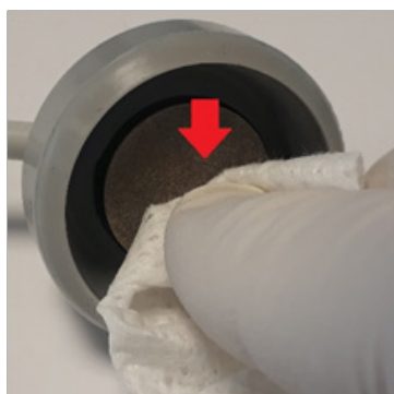
Afbeelding 2: Het contactoppervlak reinigen
