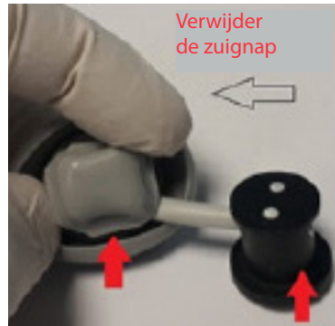
Figuur 9: Verwijder de afzuigkap
