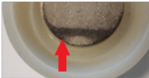
Abbildung 14: Fehlerbild - Verfärbung der Elektrode
