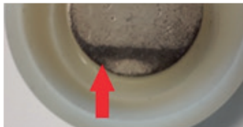
Afbeelding 14: Foutbeeld – Verkleuring van de elektrode
