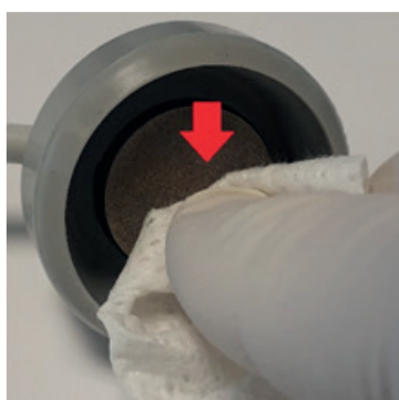
Afbeelding 7: Contactvlak reinigen (elektrode)
